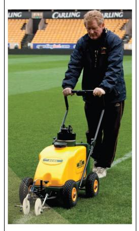
Usted puede modificar la tasa de dilución con la ayuda de unos controles al alcance de la mano sin interrumpir el marcaje. Un depósito de 5 litros contiene la pintura de marcaje y, al lado, otro depósito de 30 litros que contiene el agua limpia. Con sólo girar el botón de la tasa de dilución, puede variarla entre 1:8 y 1:20, sin dejar de trabajar.
